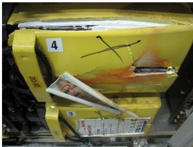
Figuur 20: Een gebarsten back-upbatterij
